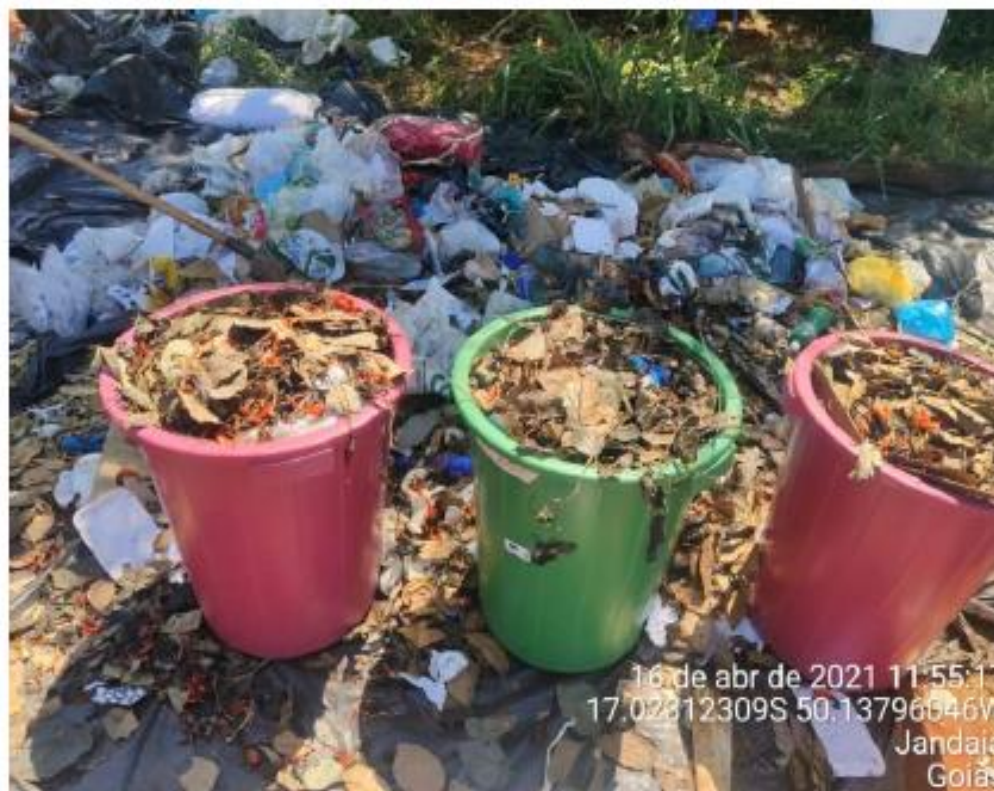
Figura 16 – Determinação do Peso Específico Aparente dos Resíduos Sólidos Domiciliares de Jandaia-GO em 16 de abril de 2021
